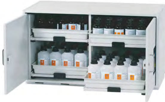
Säuren- und Laugenunterbauschrank SL-CLASSIC-UB Modell SL.060.110.UBM.2T in Lichtgrau (RAL 7035), Inneneinrichtung mit 4 x Tablarauszug (Werkstoffplatte/PP) Bestell-Nr. 38006-001-30621
